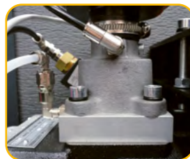
Control de la presión de trabajo con traductor (en versión tronic) El traductor garantiza un funcionamiento preciso y estable. Hace posible modificar la presión del trabajo directamente del control electrónico, sin ninguna intervención mecánica
