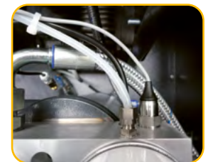
Regulador de aspiración Sistema electro-neumático normalmente abierto. Regula el funcionamiento del compresor garantizando la mínima presión necesaria durante la marcha en vacío para lograr el máximo ahorro energético
